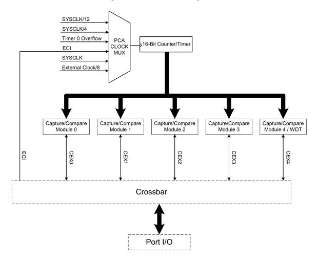
Figure 1.8. PCA Block Diagram
