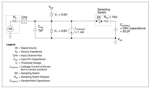
FIGURE 4-1: Analog Input Model
