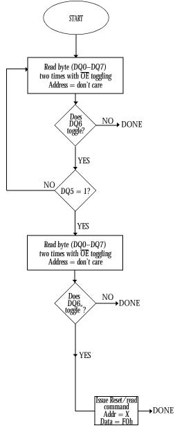
$<sup>^\</sup>ast$  DQ6 rechecked even if DQ5 = 1 because DQ6 may stop toggling when DQ5 changes to 1.
