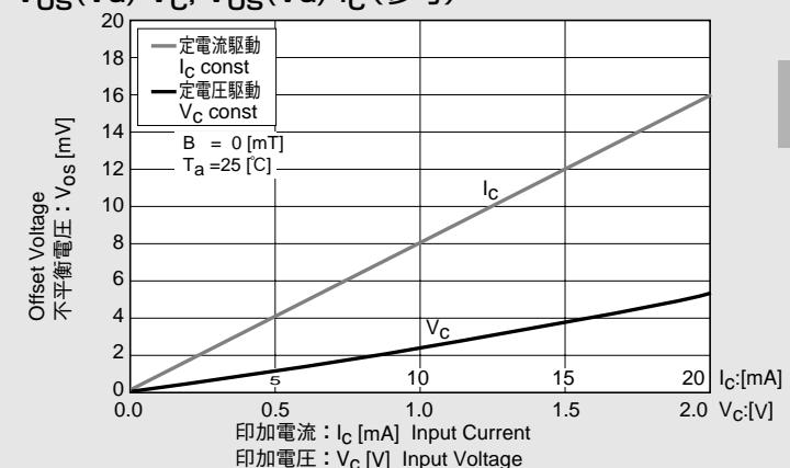
定電圧駆動 R<sub>in</sub>=340[Ω]、V<sub>OS</sub>=2.4[mV] [V<sub>C</sub>=1[V]]の例
