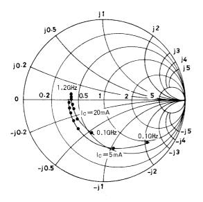
S12e:  $V_{CE}$ = 3 V f=100MHz, 200 to1200MHz(200MHz step)
