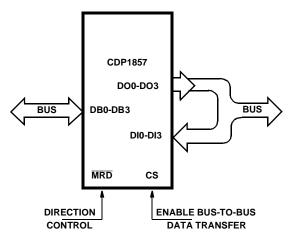
FIGURE 2. CDP1857 BIDIRECTIONAL BUS BUFFER OPERATION
