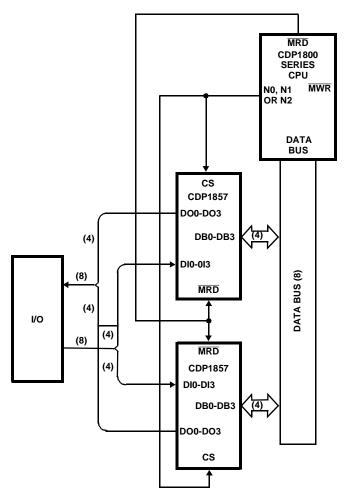
FIGURE 3. CDP1857 BUS SEPARATOR OPERATION
