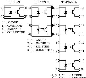
1, 3, 3, 7 : ANODE 2, 4, 6, 8 : CATHODE 9, 11, 13, 15 : EMITTER 10, 12, 14, 16 : COLLECTOR
