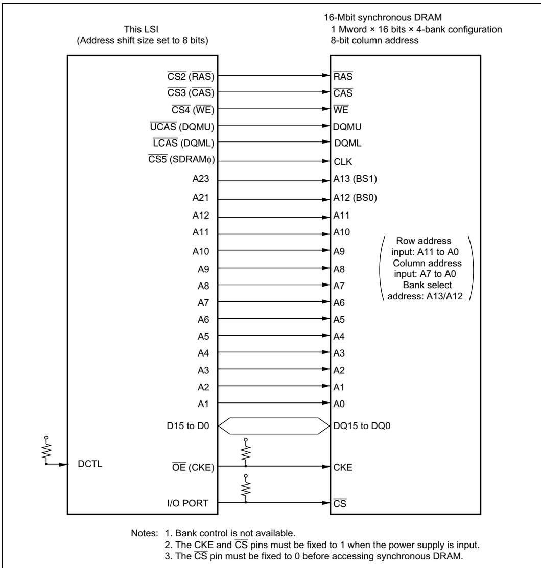
**Figure 6.51 Example of DQMU and DQML Byte Control**
