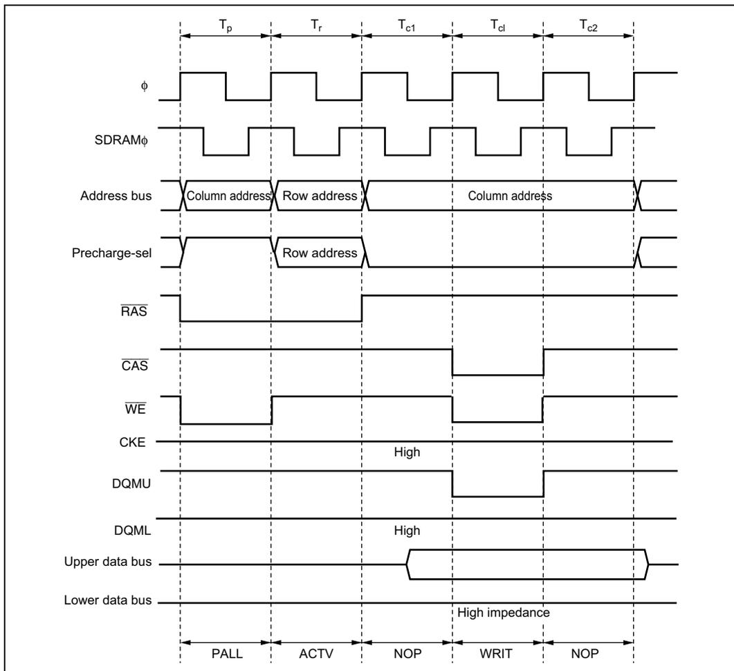
**Figure 6.49 DQMU and DQML Control Timing**
