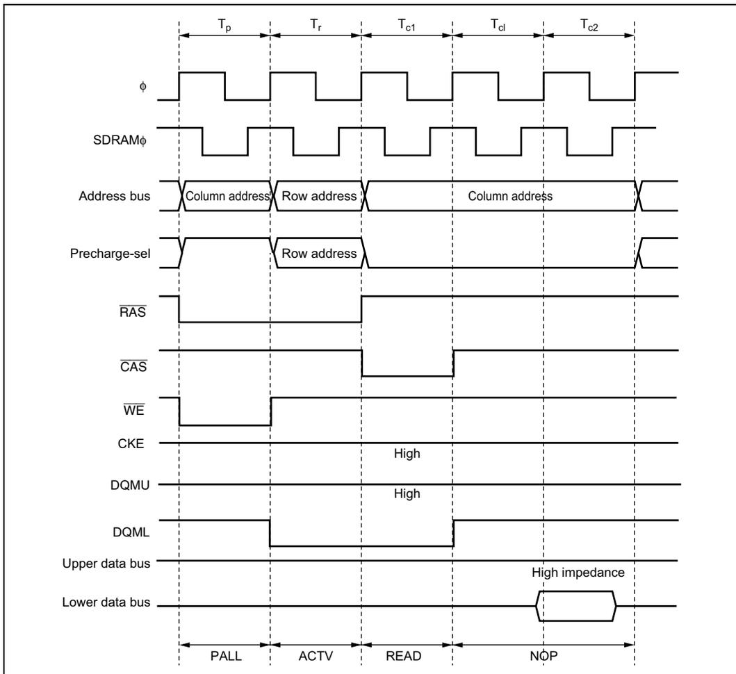
**Figure 6.50 DQMU and DQML Control Timing
