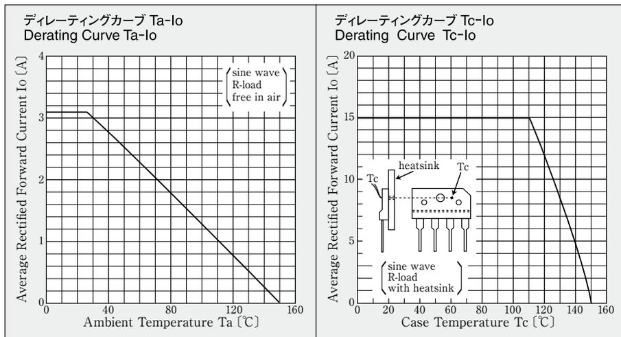
\* Sine wave は 50Hz で測定しています。
