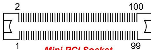
Mini PCI Socket pin orientation
