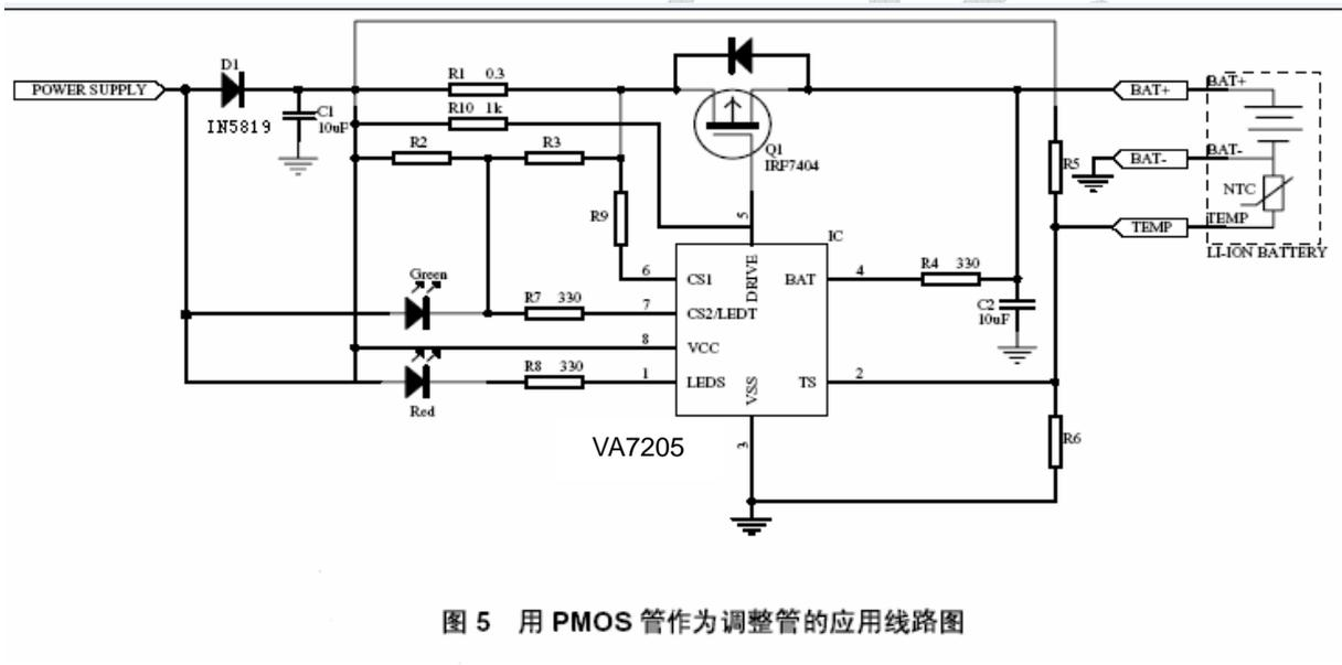
图 5 用 PMOS 管作为调整管的应用线路图
