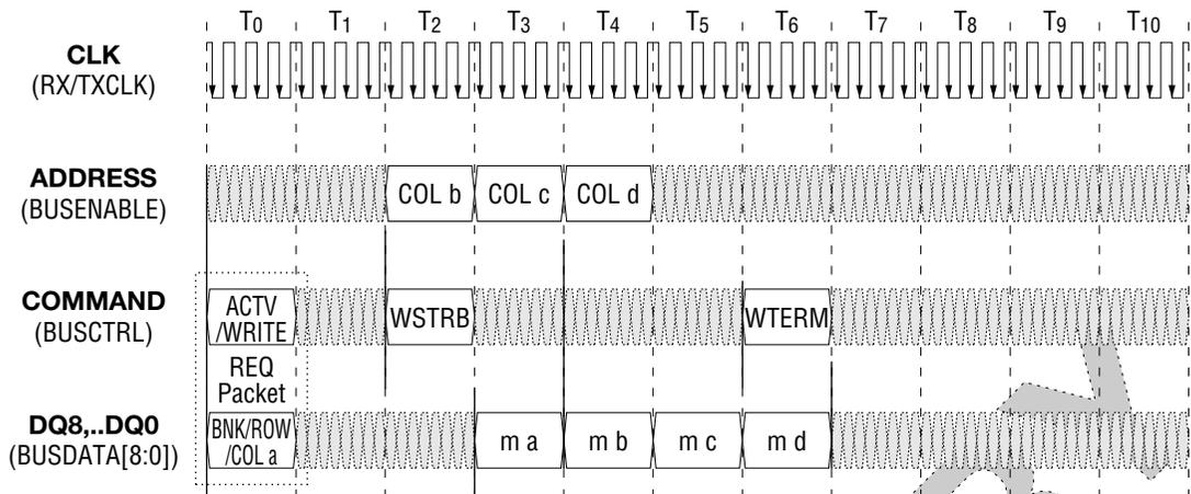
(c) OP5, OP4 = 1, 1 - BITMASK FROM DQ INPUTS, DATA IN MASK REGISTER
