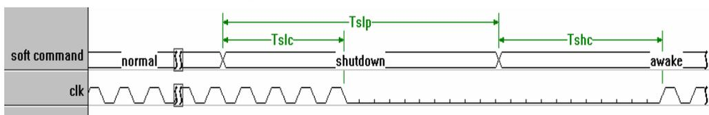
图 6 软件 shutdown/唤醒时序图
