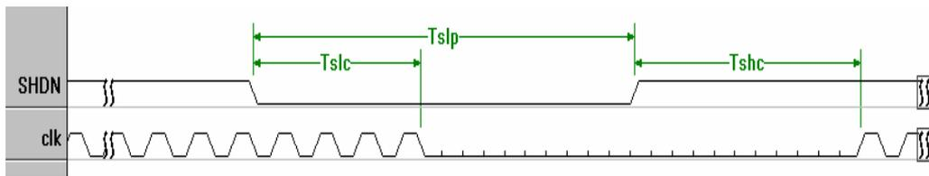
图 7 硬件 shutdown/唤醒时序图
