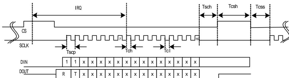
图 2 SPI 接口时序图
