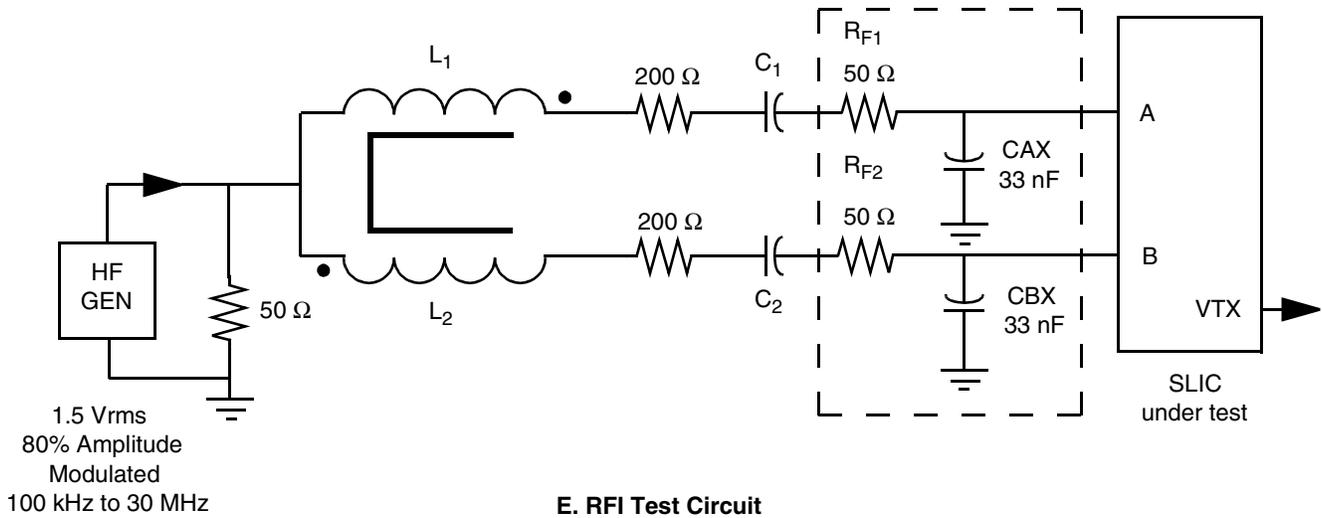
**E. RFI Test Circuit**
