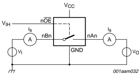
V<sub>I</sub> = V<sub>CC</sub> or GND and V<sub>O</sub> = GND or V<sub>CC</sub>.
