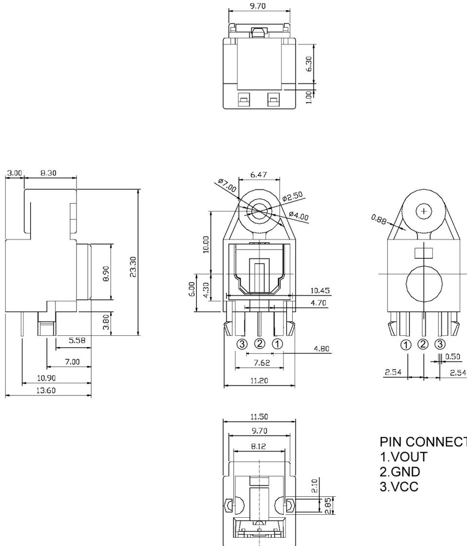
RECOMMENDED DRILLING AS VIEWED FROM THE SOLDERING FACE
