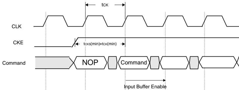
B )  $t_{CK} \geq t_{CKS(min)} + t_{CK(min)}$
