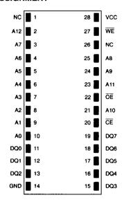
28-PIN ENCAPSULATED PACKAGE 720 MIL EXTENDED
