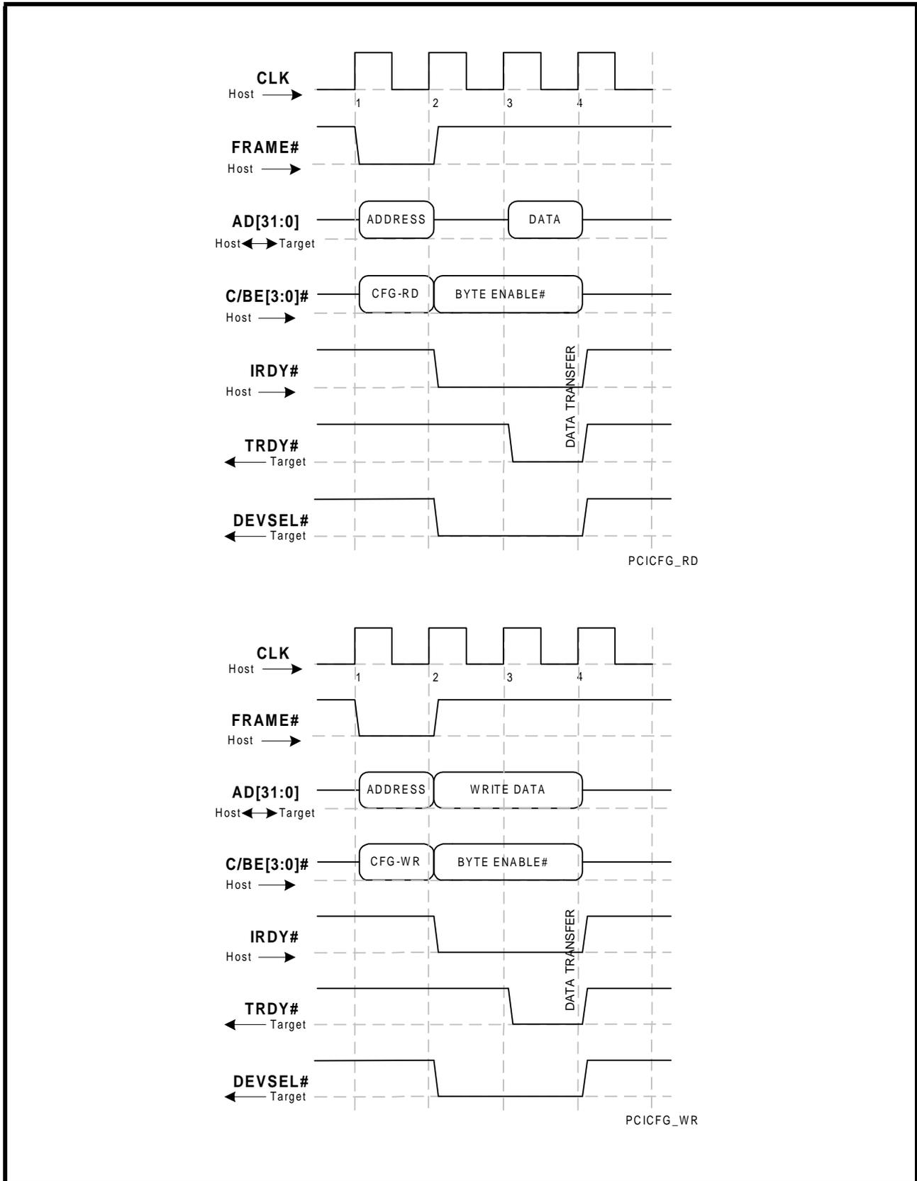
**FIGURE 19. DEVICE CONFIGURATION AND UART REGISTERS READ OPERATION FOR A BYTE OR DWORD**
