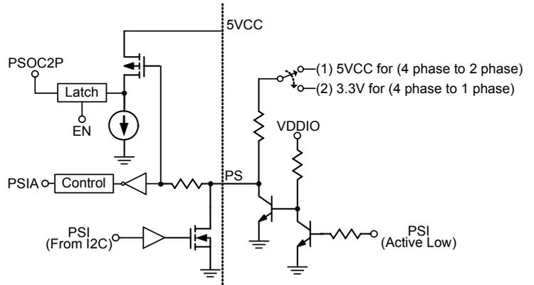
Figure 14. Power-Saving-Mode Circuit
