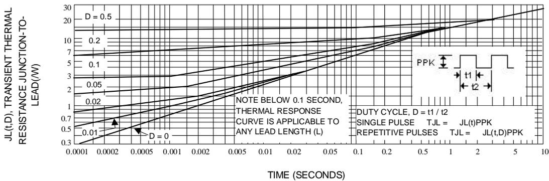
Fig. 3-TYPICAL THERMAL RESPONSE
