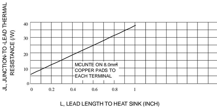
Fig. 4-TYPICAL THERMAL RESISTANCE
