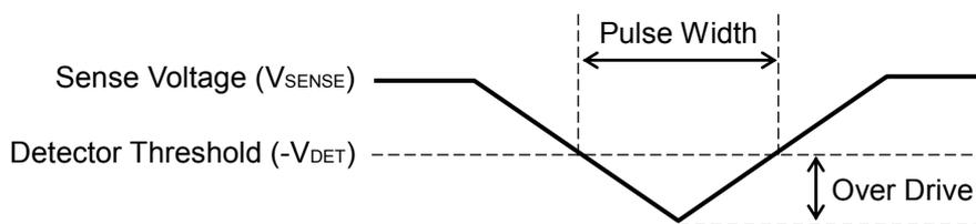
**V<sub>SENSE</sub> Input Waveform**
