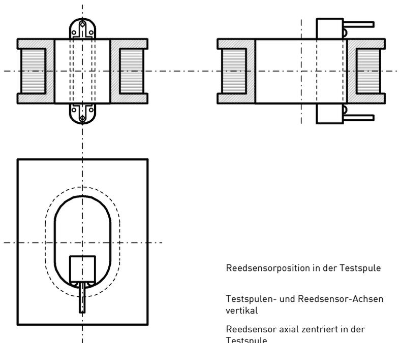
Reedsensorposition in der Testspule
