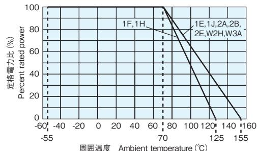
周囲温度70°C以上で使用される場合は、上図に示す負荷軽減曲線に従って、定格電力を軽減して御使用ください。
