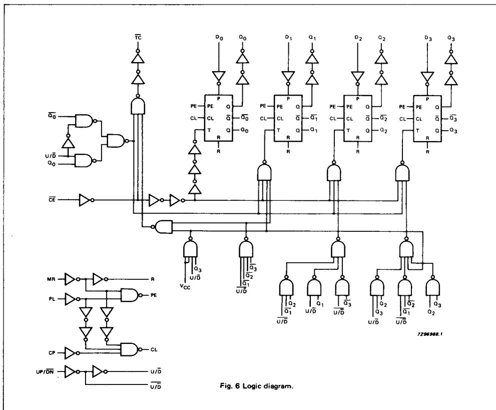
**Fig. 6 Logic diagram**
