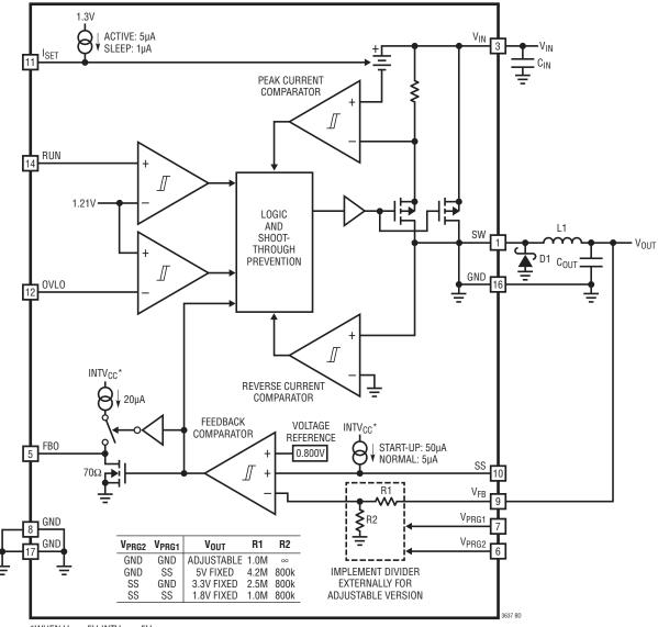
\*WHEN V<sub>IN</sub> > 5V, INTV<sub>CC</sub> = 5V WHEN V<sub>IN</sub> ≤ 5V, INTV<sub>CC</sub> FOLLOWS V<sub>IN</sub>
