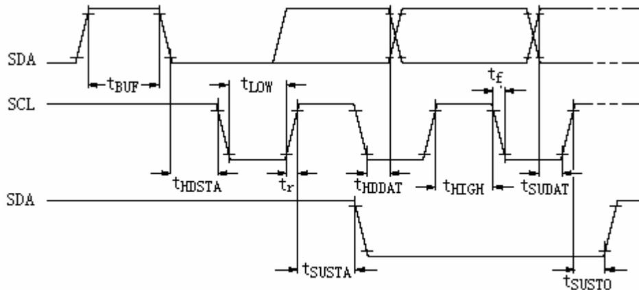
图3. I<sup>2</sup>C总线时序波形
