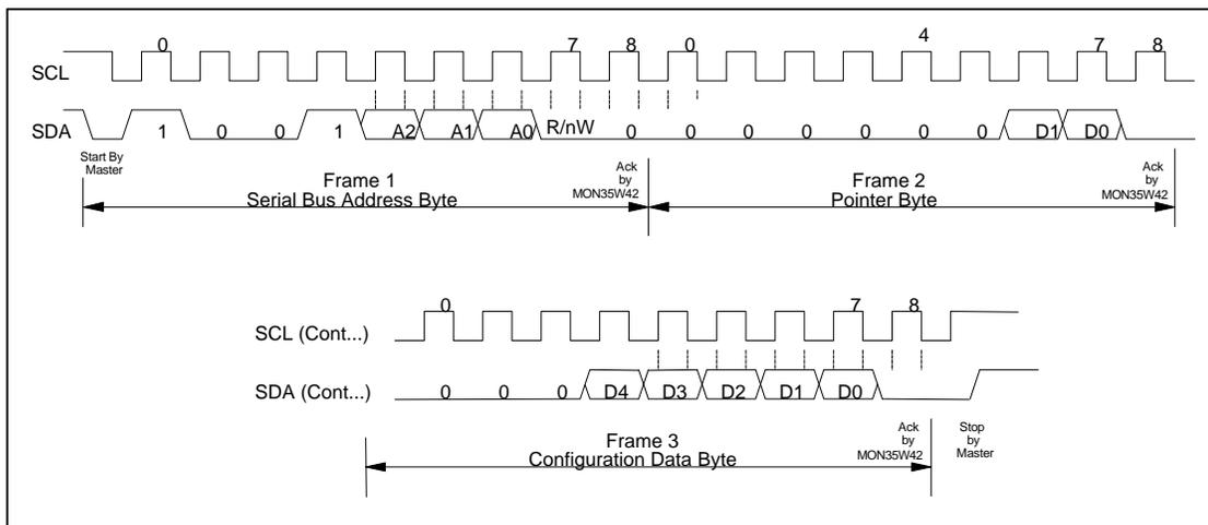
**FIGURE 8 - TEMPERATURE 2/3 CONFIGURATION REGISTER WRITE**
