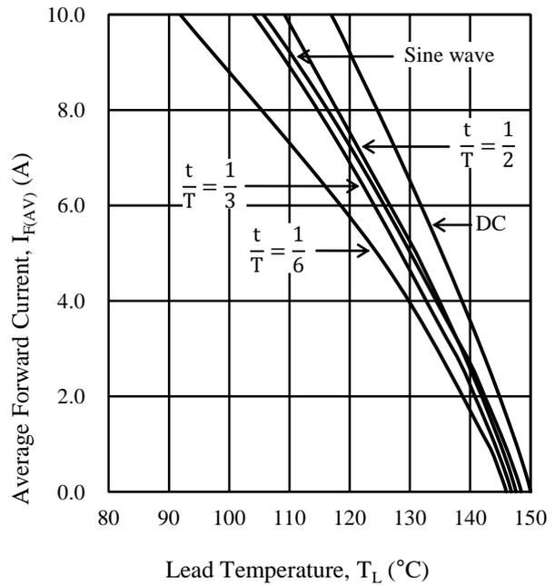
Figure 3-13  $I_{F(AV)} - T_L$  ( $V_R = 200\text{ V}$ )
