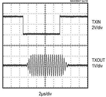
**RECEIVER PROPAGATION DELAY AT 9.6kbps**
